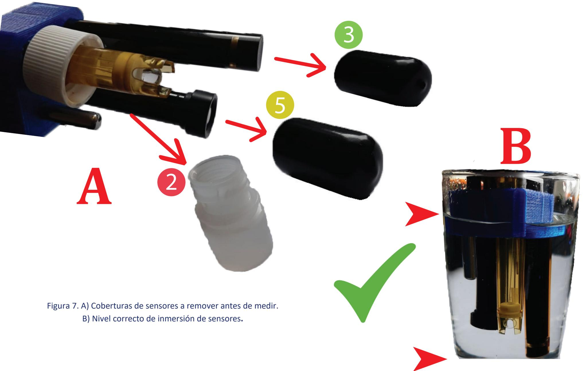
Figura 7. A) Coberturas de sensores a remover antes de medir.
